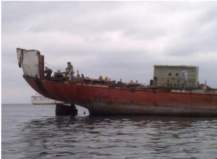
**Ilustración 18 Buque Jet Mark en proceso de desguace.**
