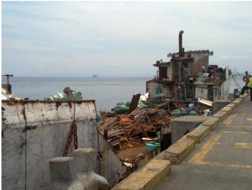
**Ilustración 10 Buque Jet Mark en proceso de desguace.**
