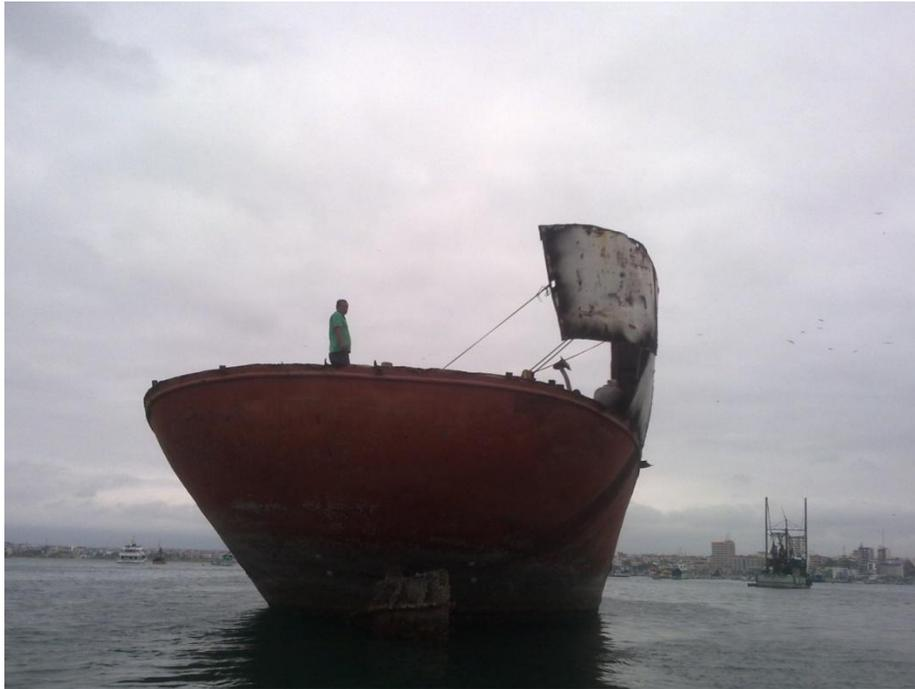
**Ilustración 19 Buque Jet Mark en proceso de desguace.**
