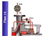
**Diseño.-** Recirculación desde la cámara del sello hacia la succión de la bomba a través de una placa de orificio.
