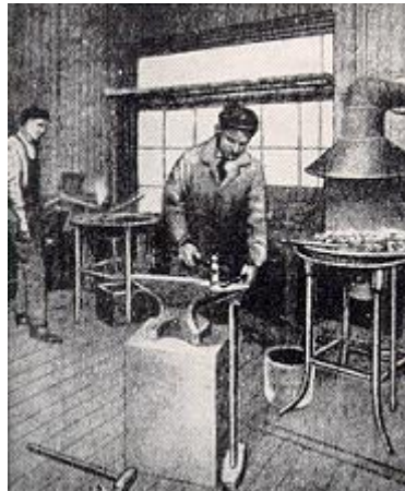
Soldadura por forja (Foto # 2)
