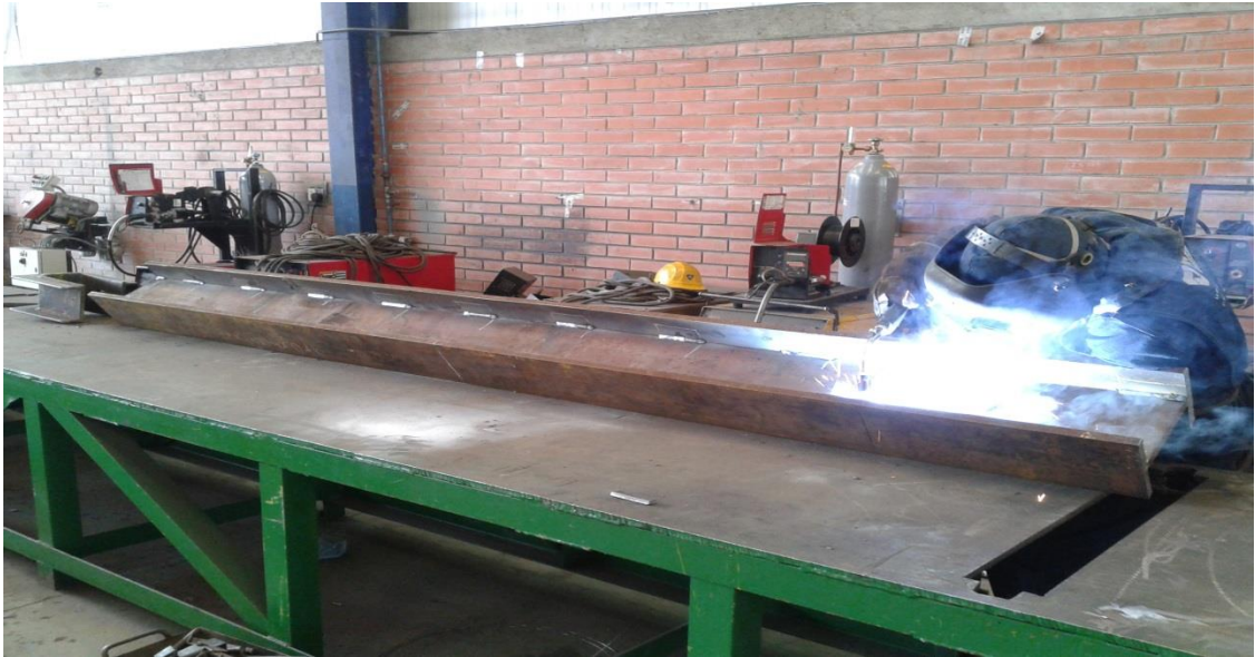
Foto No. 1: Típica fabricación de vigas en taller de soldadura
