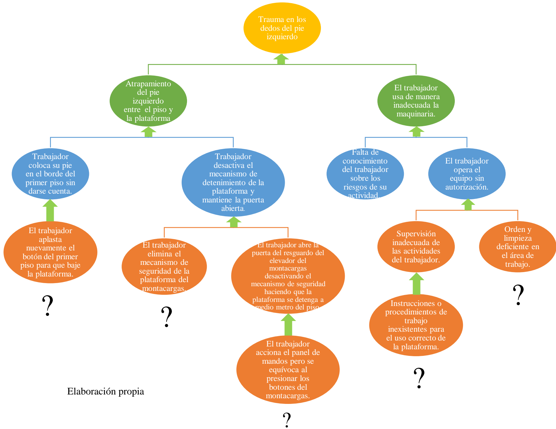
Figura N° 15 Árbol de Causas Accidente Laboral 1
