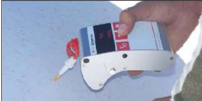
Figura 5. Muestreo del nivel de O<sub>2</sub> y CO<sub>2</sub> con un medidor portátil de gases.
