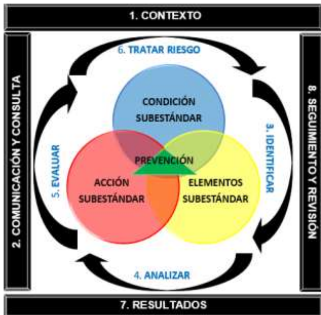
Figura 4. Estructura del modelo de manejo de riesgo mecánico.
