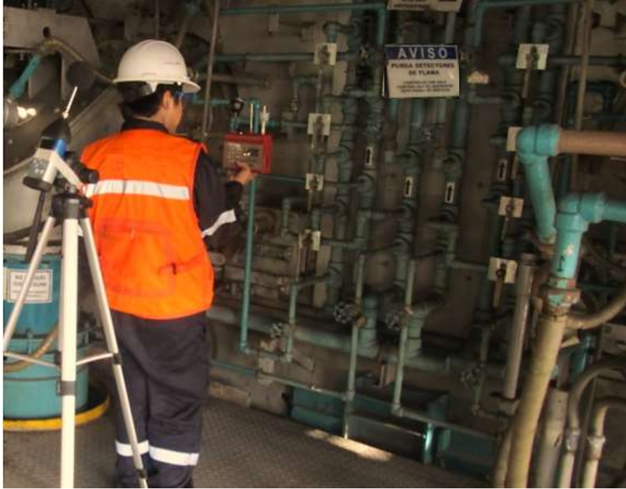
Ilustración 11: Análisis acústico con sonómetro de la entrada de bombas del BT Jambelí
