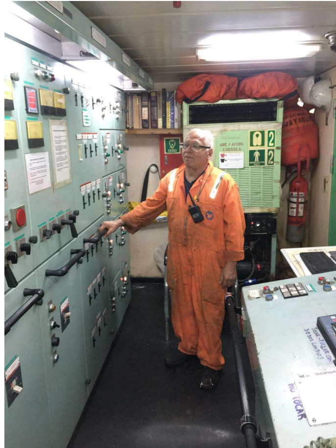
Ilustración15: Análisis acústico con un dosímetro en la consola de máquinas del BT Jambelí
