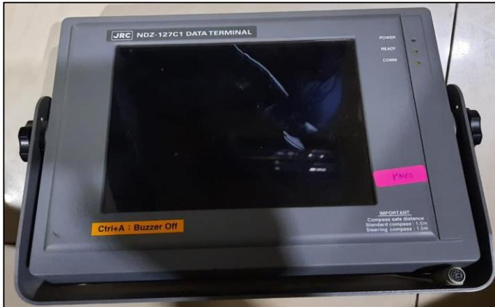
*Figura 36.- CONSOLA JRC NDZ del sistema NAVTEX*
