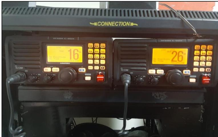
*Figura 32.- Equipo TX/RX VHF-FM CON DSC.- ICOM IC-M604
