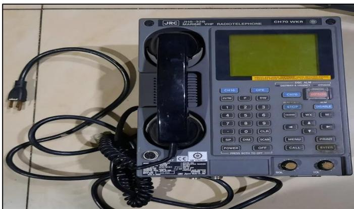
*Figura 37.- Equipo transceptor VHF DSC*
