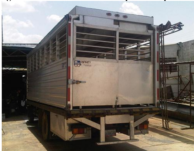
Figura No.4.85. Diseño carrocería para transportar cerdos
