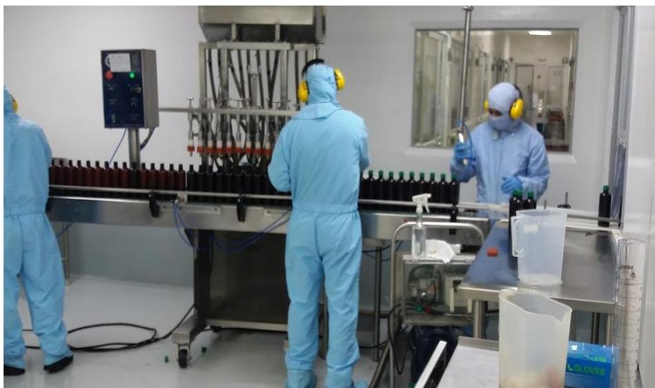
**Figura: 25** Área para el proceso de envasado de líquidos – Máquina processadora
