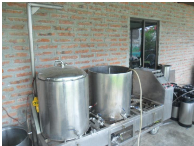
Figura 30 Planta de cocción en el taller de Joachim Schulze
